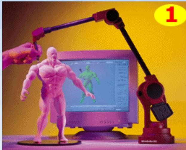
Scanner de Toque com Braço Mecânico
